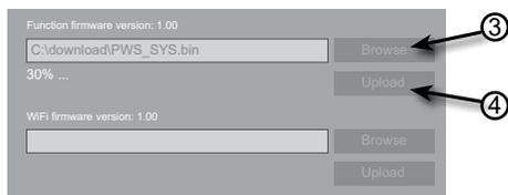
5. Основной блок обновится автоматически после того, как файл программного обеспечения будет получен. На левой части экрана отобразится прогресс обновления (т. е. значение 100 обозначает завершение обновления).
