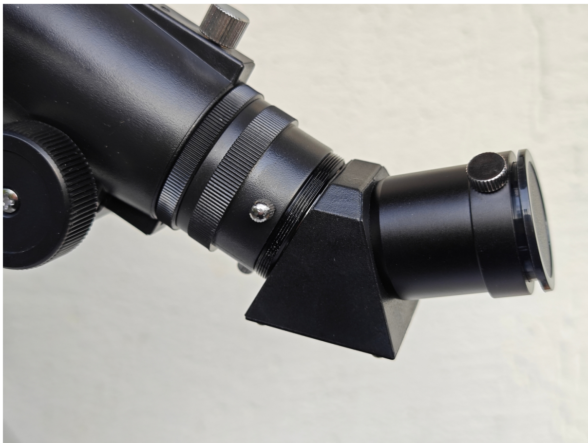
Устанавливаем оборачивающую призму
