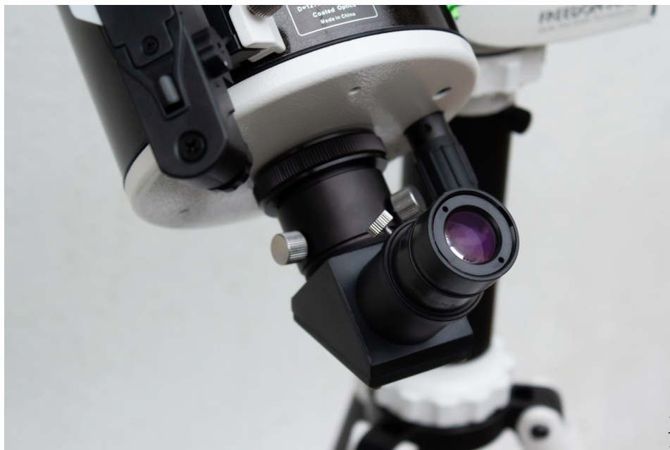
Диагональное зеркало с установленным окуляром
