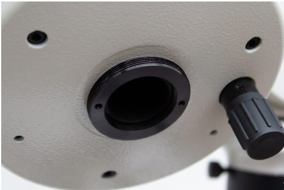
Визуальный адаптер снят
