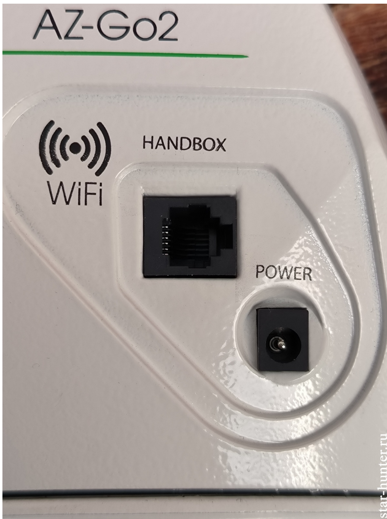
Разъемы на монтировке
