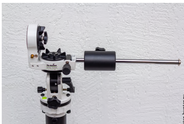
Альт-азимутальный режим с противовесом
