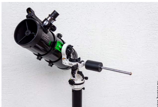
Труба на монтировке в альт-азимутальном режиме
