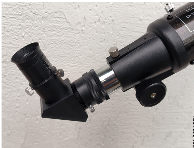
Диагональное зеркало, установленное в фокусер
