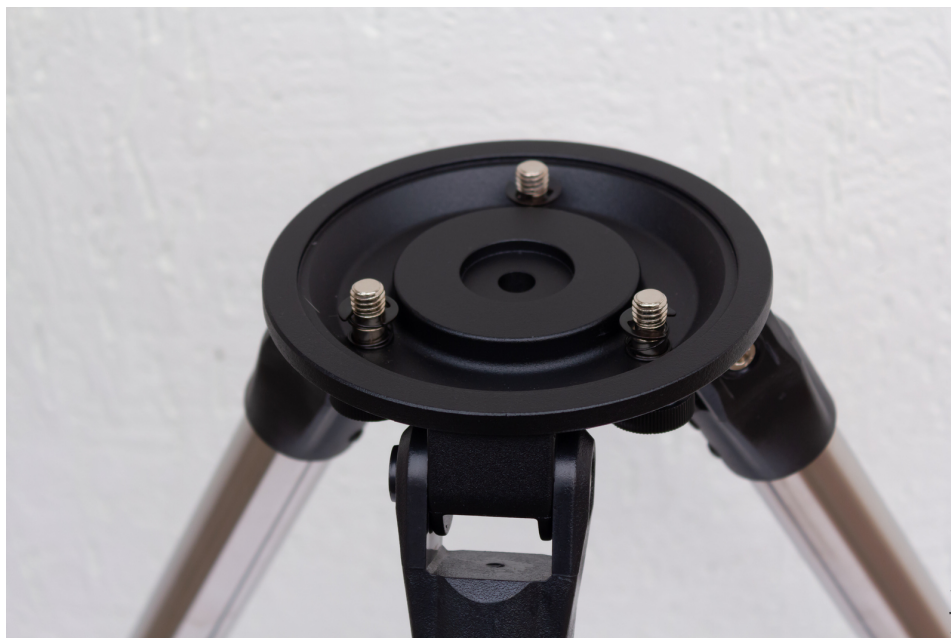
Место соединения с головой монтировки
