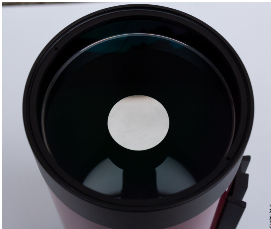
Мениск с напыленным вторичным зеркалом
