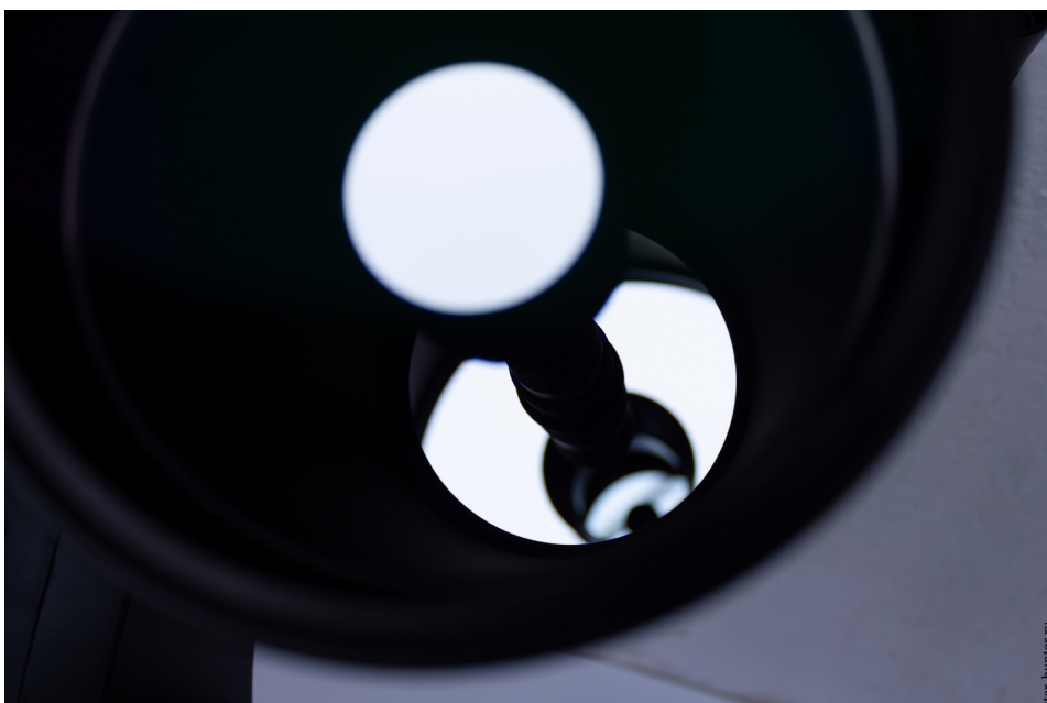
Главное зеркало внутри трубы
