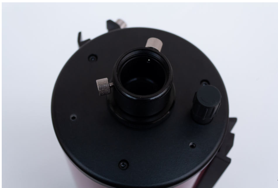
Задняя часть трубы. Видны винты для юстировки, ручка фокусера, а также визуальный адаптер
