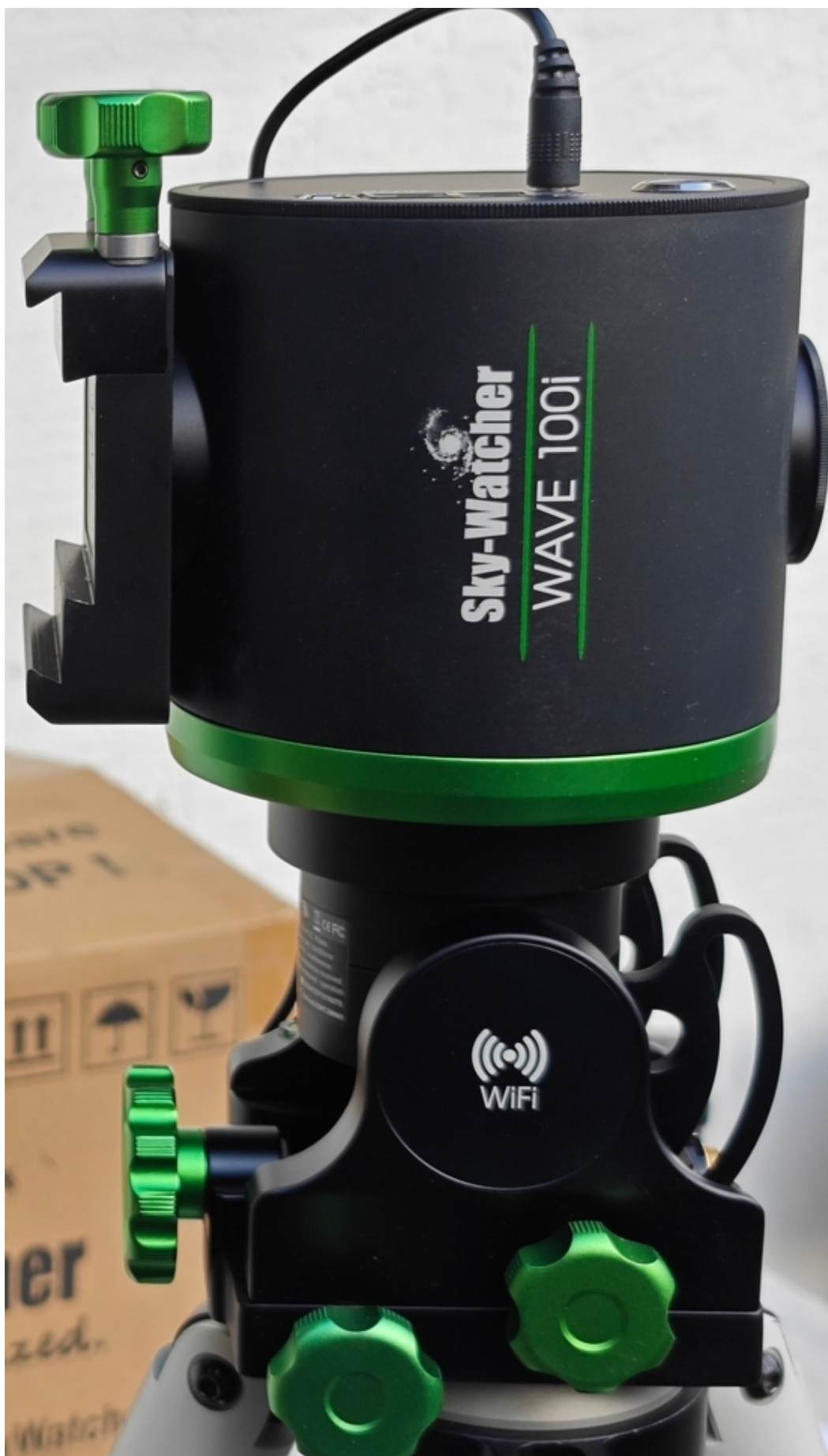
Стартовое положение для AZ-режима. Слева — восток, справа — запад, прямо — юг, сзади — север. Крепежная площадка расположена горизонтально.
