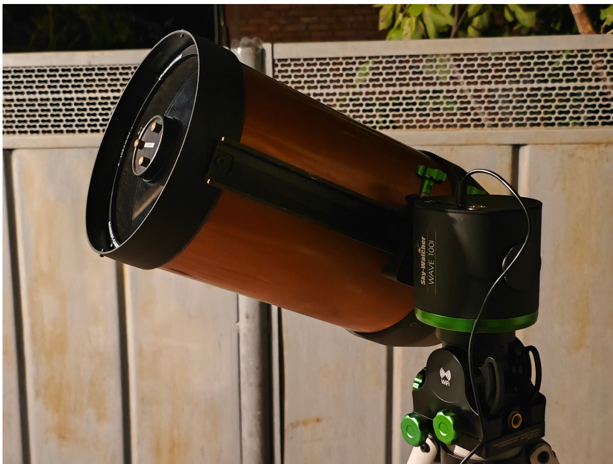
Шмидт-Кассегрен 203 мм в альт-азимутальном режиме
