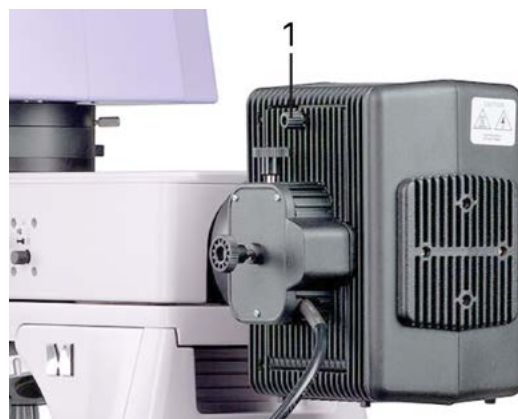
Рис. 27. Замена лампы осветителя отраженного света
