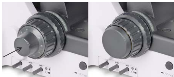
Рис. 16. Смена рукояток тонкой фокусировки
