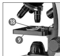
Leg nu een houdbaar preparaat (18) direct onder het objectief op de microscooptafel. Het te observeren object dient hierbij precies boven het lampje (10) te liggen.
