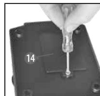
Na base do microscópio encontrares o compartimento das pilhas (14). Desaperte o parafuso de fixação do compartimento da bateria com uma pequena chave de fenda
