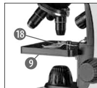
Agora coloca um preparado permanente (18) directamente por baixo da objectiva na mesa do microscópio (fig. 3). O objecto a ser observado deve encontrar-se mesmo por baixo da iluminação (10).
