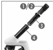
Inserisci ora l'oculare 10x (1) nella lente di Barlow (3). Assicurati che la lente di Barlow non sia sollevata, ma che sia invece ben inserita nel portaoculare (4).
