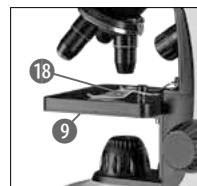
Nun lege ein Dauerpräparat (18) direkt unter dem Objektiv auf den Mikroskopisch. Das zu beobachtende Objekt soll hierbei genau über der Beleuchtung (10) liegen.
