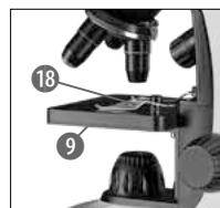
Maintenant, pose une préparation durable (18) directement sous l'objectif sur la table du microscope. L'objet à observer ne doit pas être placé directement sur l'éclairage (10).
