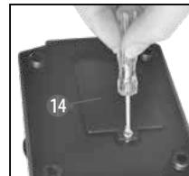
Nella base del microscopio si trova il vano batterie (14). Aprire delicatamente il coperchio del vano batterie.
