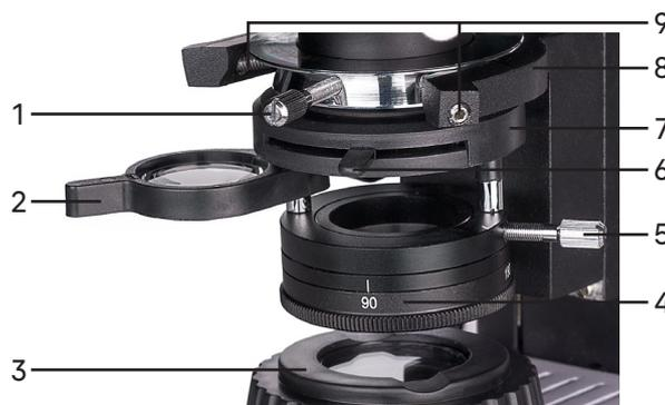
Рис. 7. Осветительная система проходящего света
