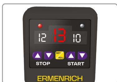
– raffreddamento, la temperatura di avvio è superiore alla temperatura di arresto
