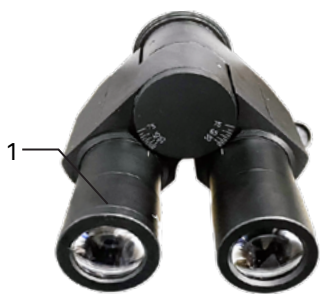
Рис. 7. Регулировка диоптрийной системы
