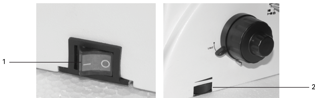
Рис. 4. Включение освещения и регулировка яркости горения лампы
