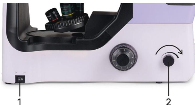
Рис. 4. Включение освещения и регулировка яркости горения лампы
