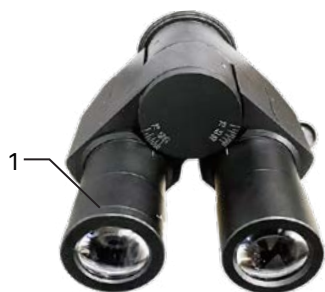
Рис. 10. Настройка механизма диоптрийной подвижки
