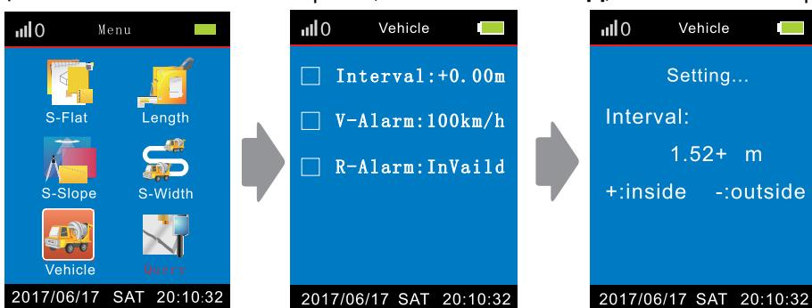
**Interval (Интервал)**    "-": измерения без учета ширины транспортного средства;
