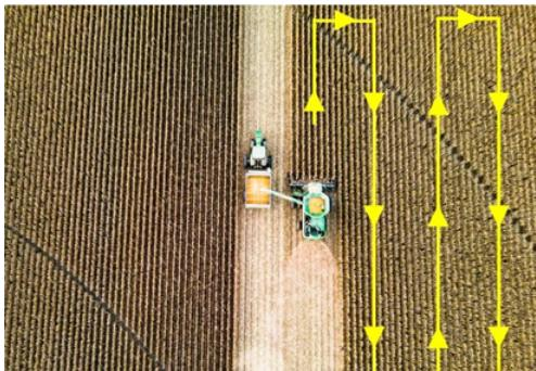
Выберите «Ширина» в меню, затем нажмите **ВВОД** для входа в интерфейс для проведения измерений. Режим подходит для измерения большого участка земли правильной формы, который подлежит обработке с помощью сельскохозяйственной техники. Введите ширину транспортного средства, нажмите **СОХРАНИТЬ** для подтверждения данных, а затем нажмите **ВВОД** для расчета пути движения. В процессе измерения прибор должен располагаться в центре кабины транспортного средства.
