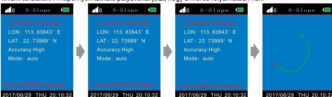
A mérések befejezéséhez nyomja meg az **ENTER** gombot. Az eredmények megjelennek a képernyőn (meredekség, egységár, teljes ár, hosszúsági fok, szélességi fok, dátum).
