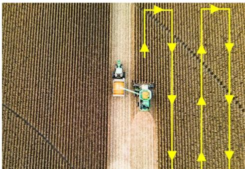
Menüde "S-Width" (S-Genişlik) öğesini seçin ve ardından ölçüm arabirimine gitmek için **ENTER'a basın**. Aracın genişliğini girin, verileri onaylamak için **KAYDET** düğmesine basın ve ardından işlemin yolunu hesaplamak için **ENTER'a basın**. Ölçüm işlemi sırasında cihaz araç kabininin merkezine yerleştirilmelidir.
