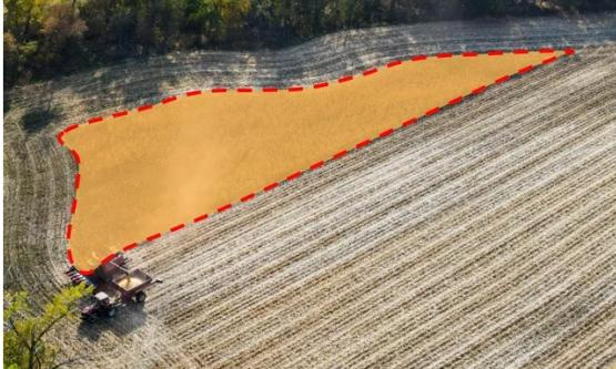
Wählen Sie im Menü "Vehicle" (Fahrzeug). Wählen Sie die Einstellungen und drücken Sie dann **EINGABE**, um die Messung zu starten. Fahren Sie um die Grenzlinie des Grundstücks und die Fläche wird dabei automatisch berechnet.
