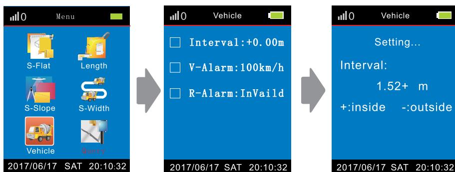
**Intervalo** “-”: sin el ancho del vehículo; “+”: con el ancho del vehículo.
