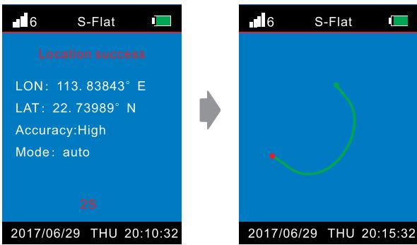
Um die Messungen abzuschließen, drücken Sie **EINGABE**. Die Ergebnisse werden auf dem Display angezeigt (Fläche, Preis pro Einheit, Gesamtpreis, Längengrad, Breitengrad, Datum).
